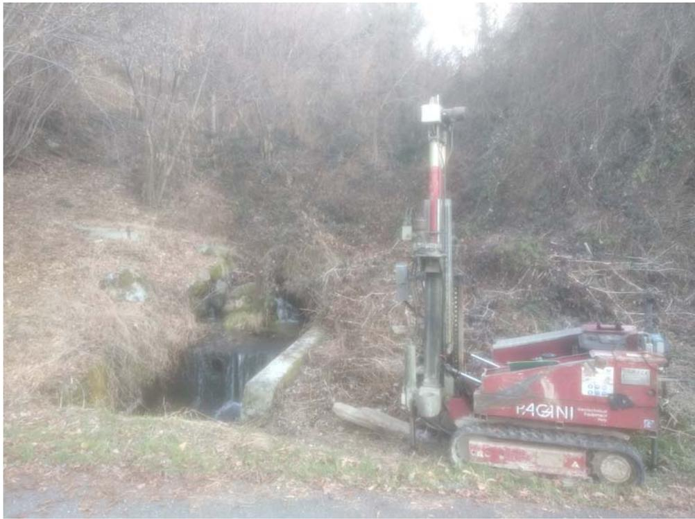
**Foto 1:** Lato attraversamento monte strada con attrezzatura prova penetrometrica Din1
