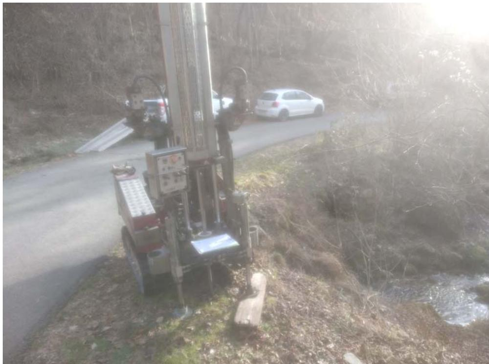
*Foto 4: Lato attraversamento valle strada con attrezzatura prova penetrometrica Din2*
